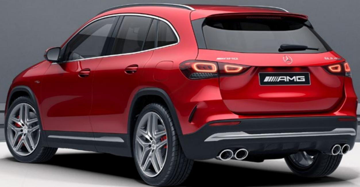
Der Mercedes-AMG GLA 45 4MATIC+ besitzt eine AMG Heckschürze mit vier vertikalen Finnen sowie eine AMG Abgasanlage mit zwei runden Doppeldrohrblenden mit je 90 mm Durchmesser.
