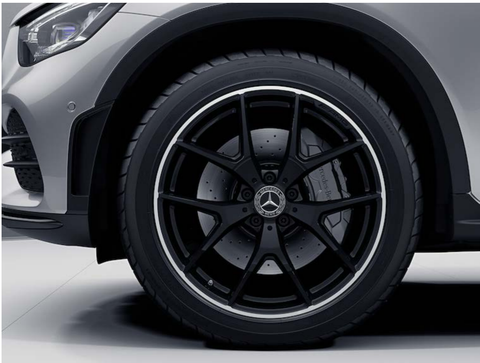
RTM - Cerchi in lega leggera da 20" AMG a 5 razze doppie verniciate in nero ultra-lucido con flangia perimetrale tornita con finitura a specchio - Di serie
