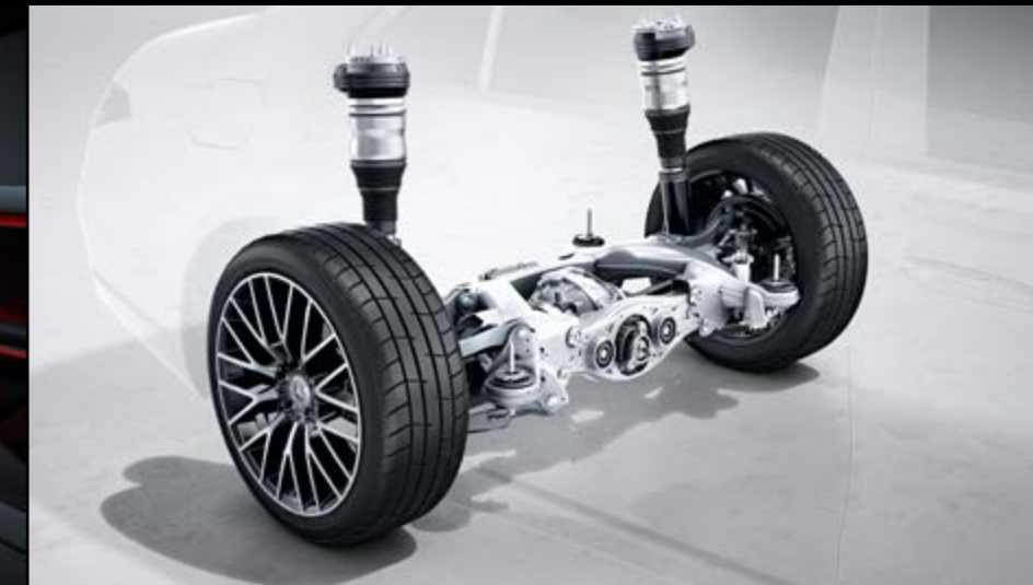
201 – Hinterachslenkung mit 3° Lenkwinkelverstellung
