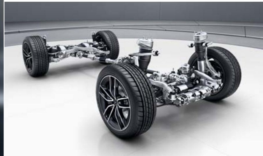
489 – AIRMATIC suspension augmente la capacité de remorquage jusqu'à 3,5 t
