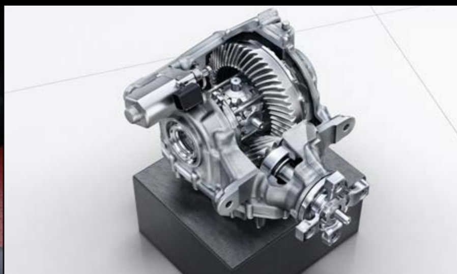
467 – Différentiel électronique autobloquant AMG sur l'essieu arrière
