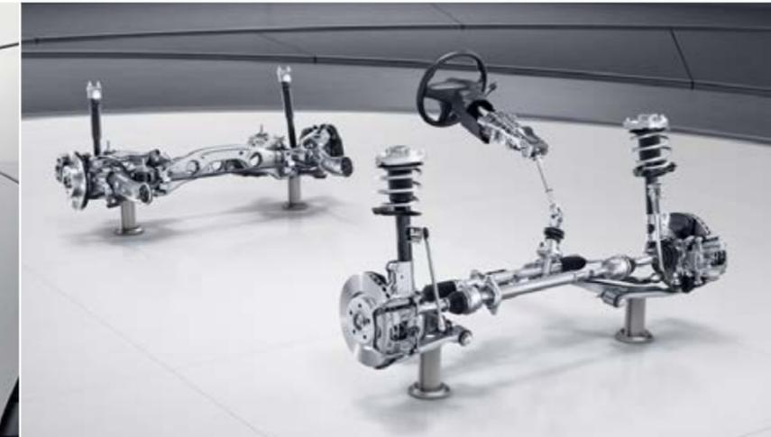
677 – Komfortfahrwerk mit Tieferlegung
