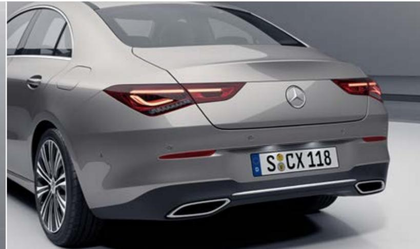
Sichtbare Endrohrblende und Heckschürze mit Chromzierleiste
