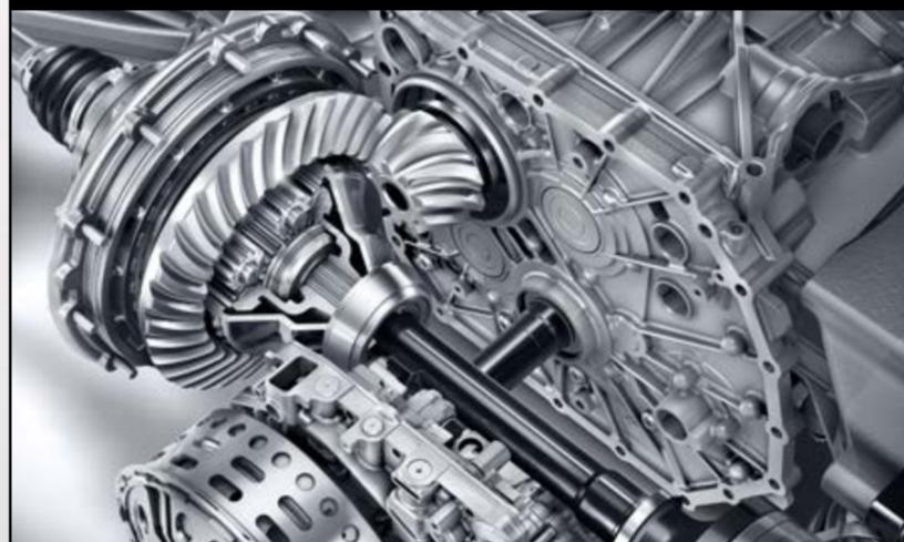
467 – Différentiel à régulation électronique de limitation du patinage sur l'essieu arrière
