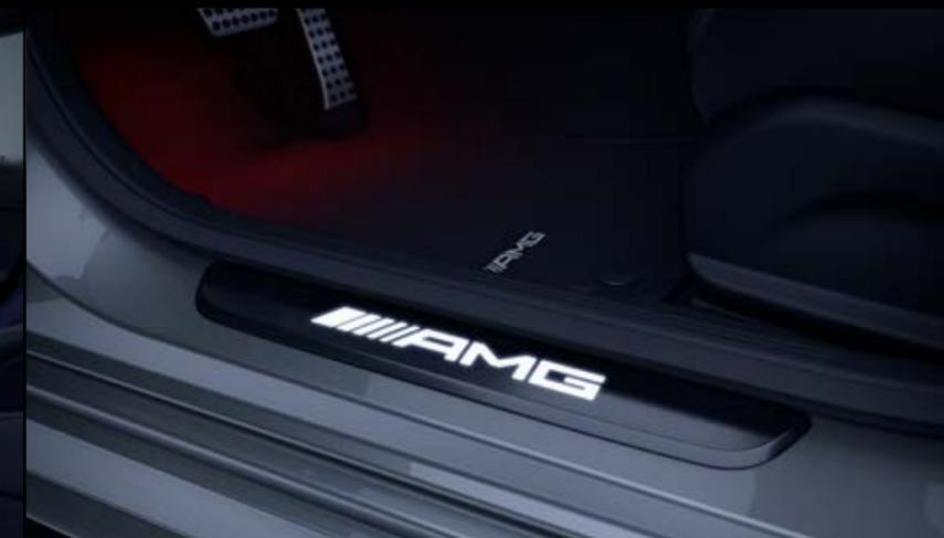
U45 – Baguettes de seuil éclairées AMG avec monogramme «AMG» et cache interchangeable
