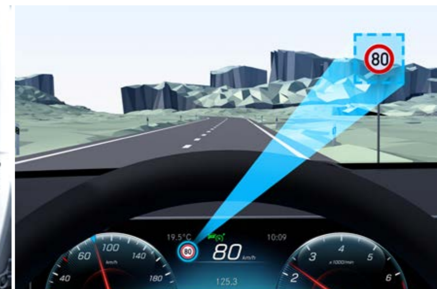
Assistant de signalisation routière (513) 1
