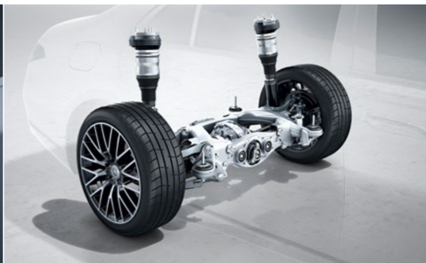
201 – Hinterachslenkung mit Einstellung des Lenkeinschlags auf 4,5°
