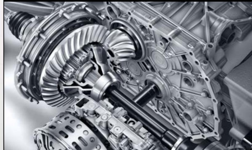
467 – AMG elektronisches Sperrdifferential Hinterachse
