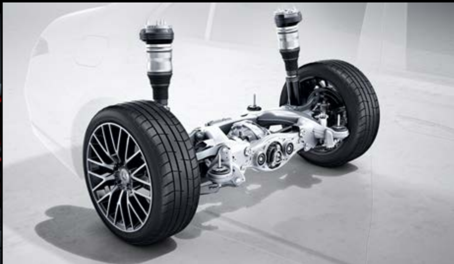
201 – Essieu arrière directeur avec réglage de l'angle de braquage à 3°
