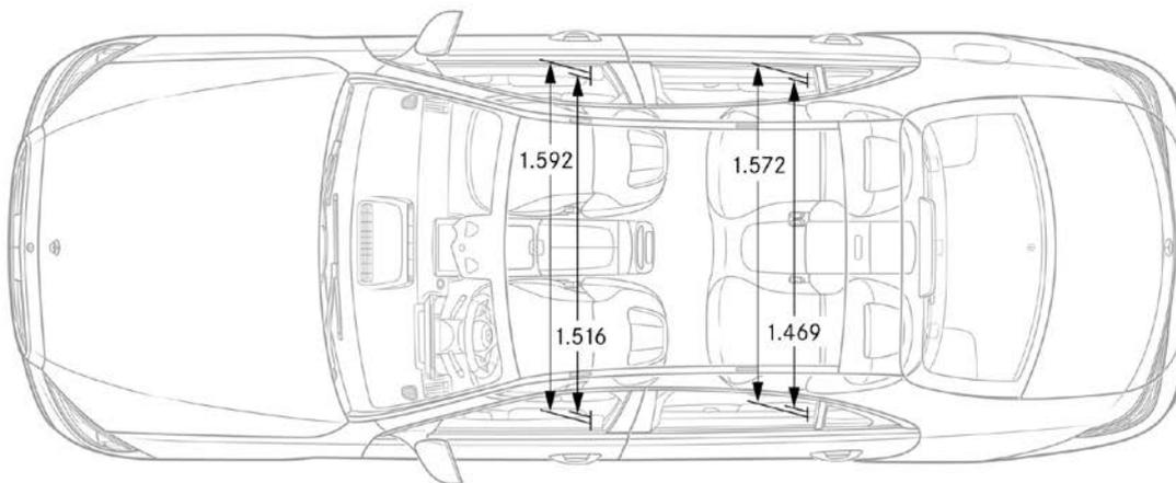
Tutti i dati sono espressi in millimetri. I valori raffigurati sono da intendersi medi e validi per vetture con equipaggiamento di base e senza carico.
