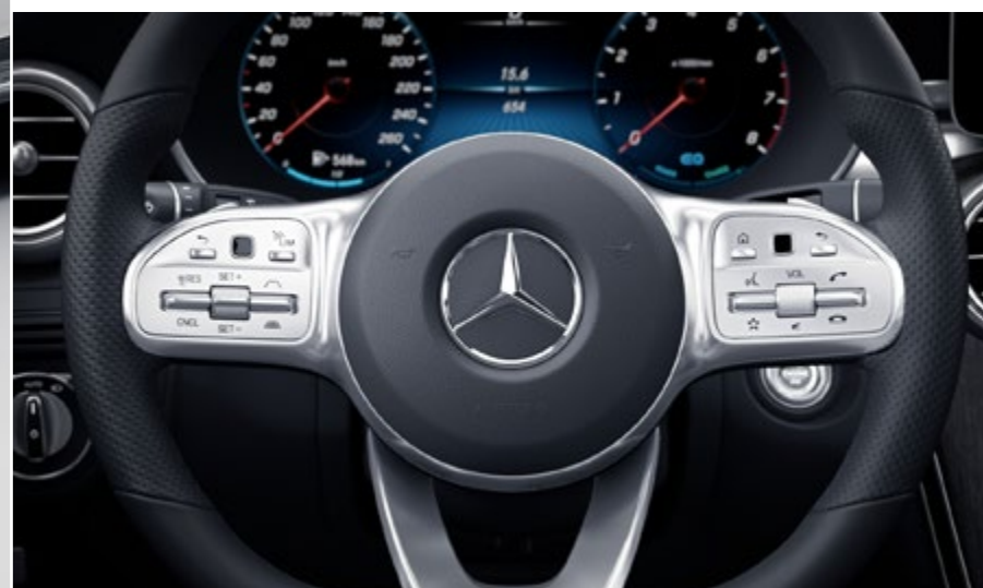
Volant sport multifonction à 3 branches revêtu de cuir Nappa noir, avec surpiqûre noire, méplat dans la partie inférieure, marquages profonds dans la zone de préhension, boutons Touch-Control et cache chromé argenté galvanisé
