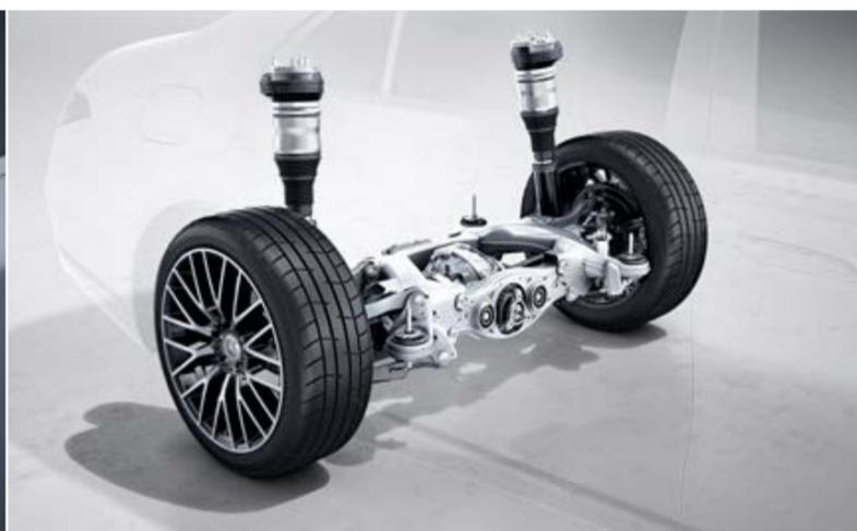
201 - Ruote posteriori direttrici con adattamento dell'angolo di sterzata di 4,5°
