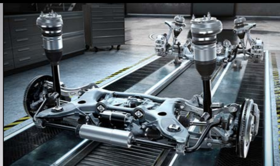
465 – AMG RIDE CONTROL+ avec AMG dynamic engine mounts (466)
