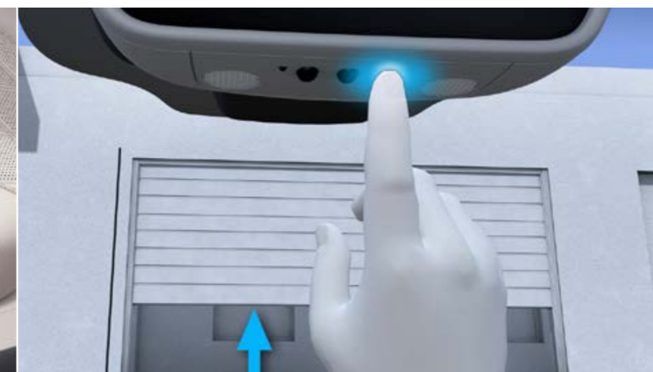
231 – Commande ouverture porte de garage
