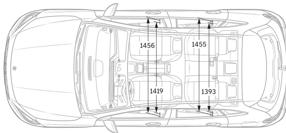
Tutti i dati sono espressi in millimetri. I valori raffigurati sono da intendersi medi e validi per vetture con equipaggiamento di base e senza carico.
