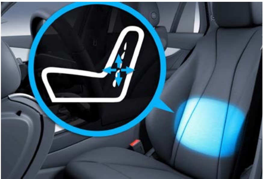
U22 - Supporto lombare regolabile su 4 parametri
