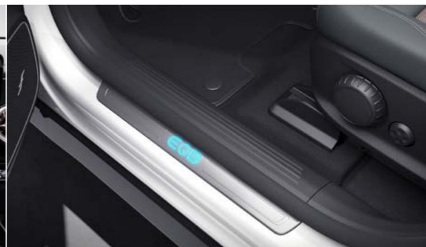
U45 - Modanature di accesso illuminate e copertura sostituibile
