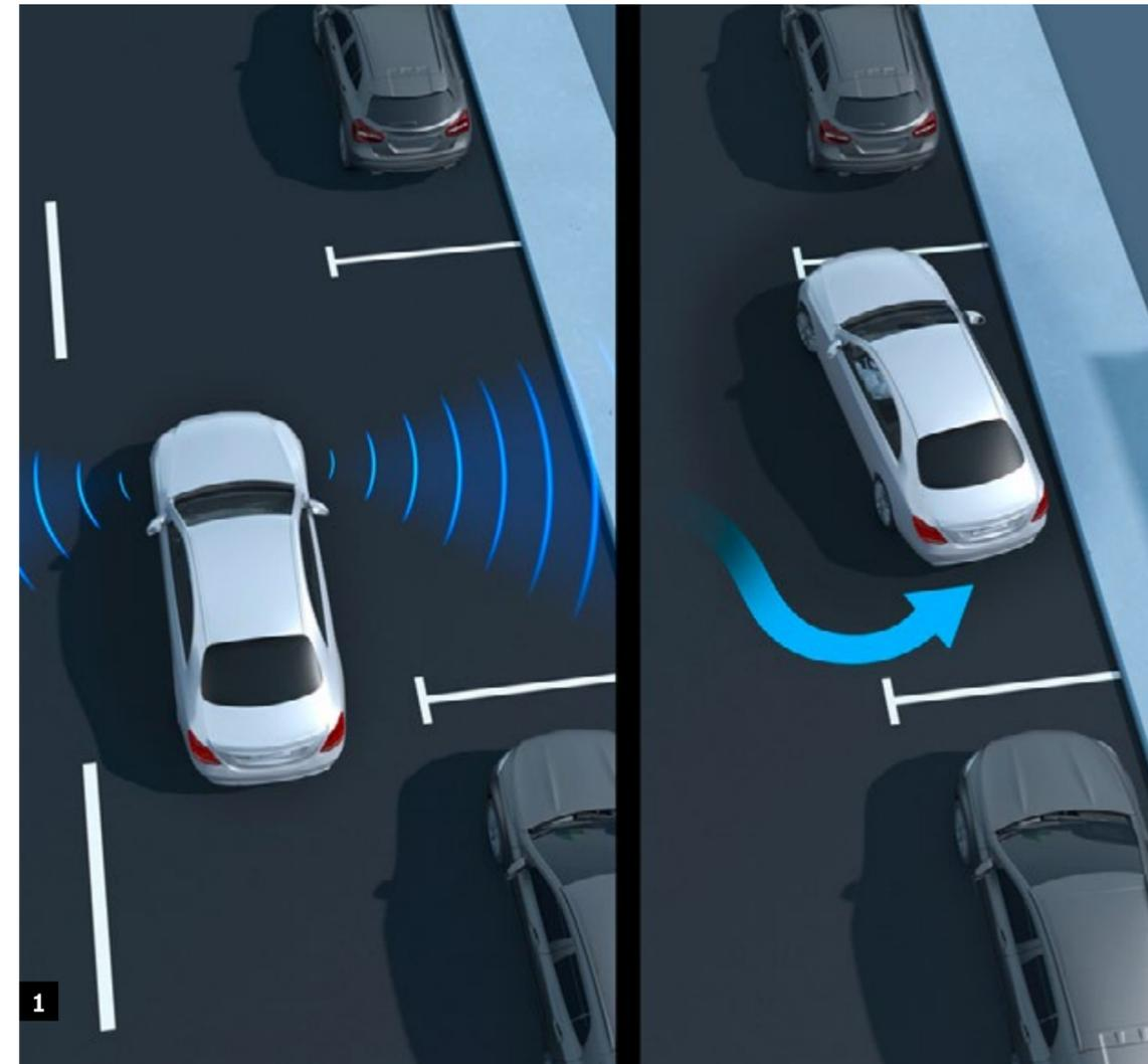
**1 P44** - Pacchetto parcheggio con telecamera per la retromarcia assistita con sistema di assistenza al parcheggio attivo con PARKTRONIC
