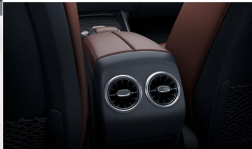
581 - Climatizzatore automatico THERMOTRONIC con bocchette centrali posteriori
