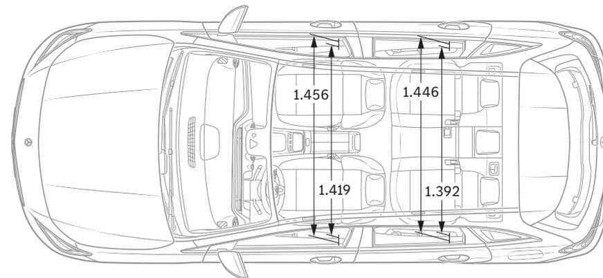
Alle Angaben in Millimetern. Die abgebildeten Maße sind Mittelwerte. Sie gelten für Fahrzeuge in Grundausstattung und in unbelastetem Zustand.
