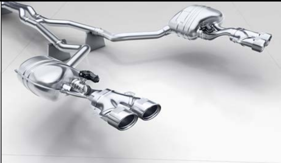
U78 – Sistema di scarico commutabile AMG Performance
