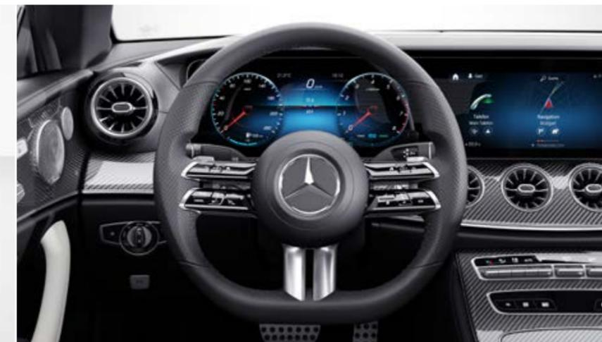
L5C - Volante sportivo multifunzione in pelle nappa con pannelli di controllo touch e paddle del cambio al volante zincati
