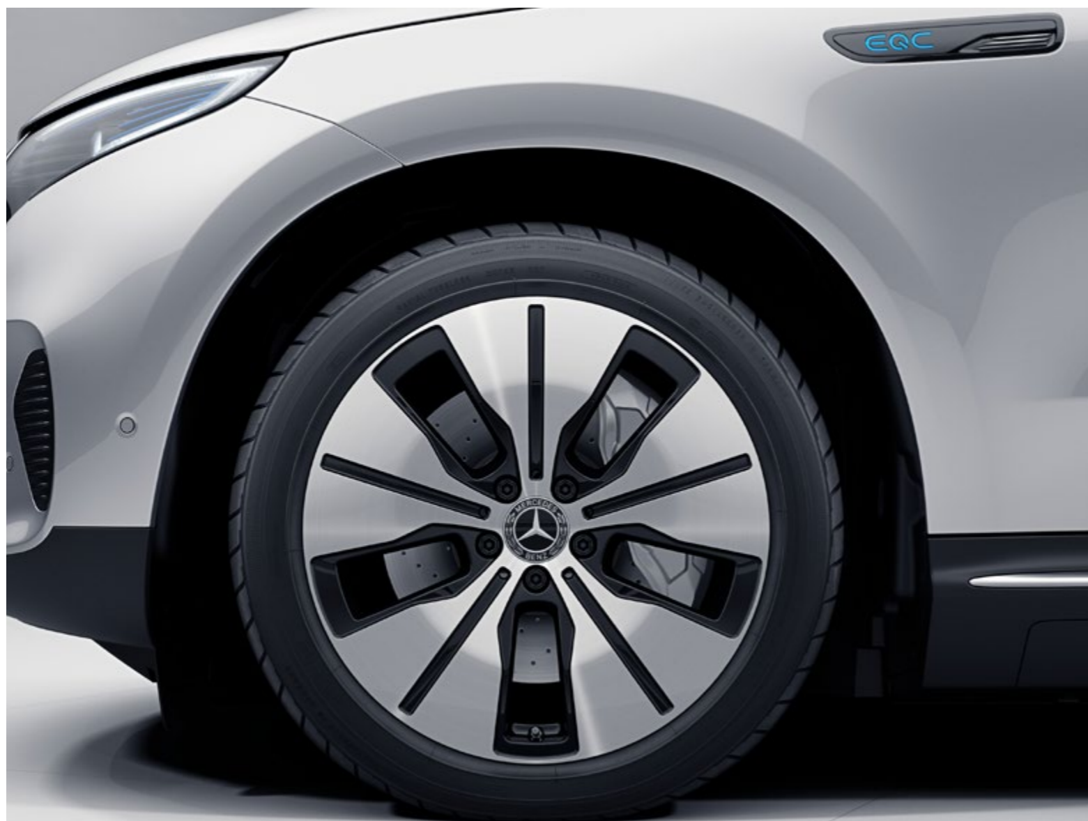
R57 – Jantes alliage de 19" à 5 branches, finition noir brillant et naturel brillant – Série Monte 235/55 R 19 sur 7,5 J × 19H2
