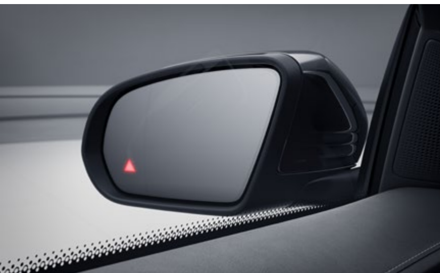
P49 – Pack rétroviseurs avec avertisseur d'angle mort (234)
