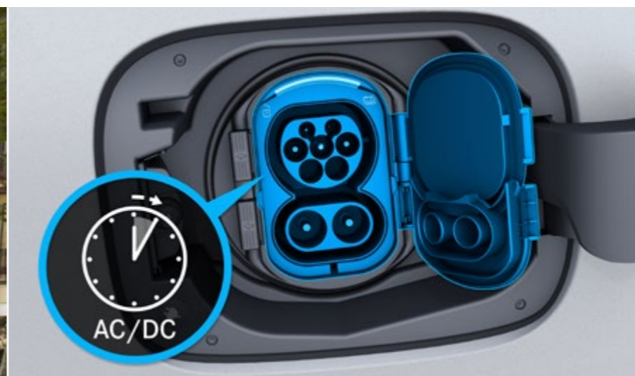
82B/83B – Système de charge à courant alternatif (charge avec du courant alternatif)/Système de charge à courant continu (charge avec du courant continu) 110 kW
