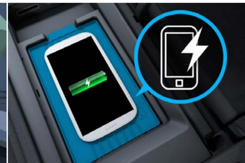
897 - Système de recharge sans fil pour appareils mobiles à l'avant
