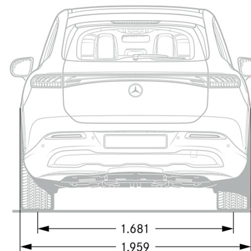
Dimensioni a vuoto <sup>1</sup>Con massa complessiva ammessa <sup>2</sup>Incluso adattatore per targa (2 mm) <sup>3</sup>Con dispositivo di traino incl. tappo di protezione (equipaggiamenti a richiesta) <sup>4</sup>Sedile posteriore scorrevole Le dimensioni sono valori medi, sono possibili piccole discrepanze.
