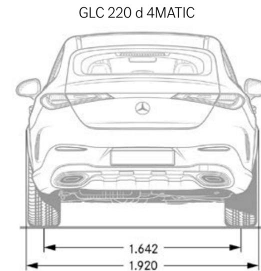
Dimensions à vide <sup>1</sup> Pour le poids total en charge admissible <sup>2</sup> Adaptateur de plaque d'immatriculation inclus (2 mm) <sup>3</sup> Avec attelage de remorque, capuchon de protection inclus (équipement spécial) Les mesures sont des valeurs moyennes, de légers écarts restent possibles.
