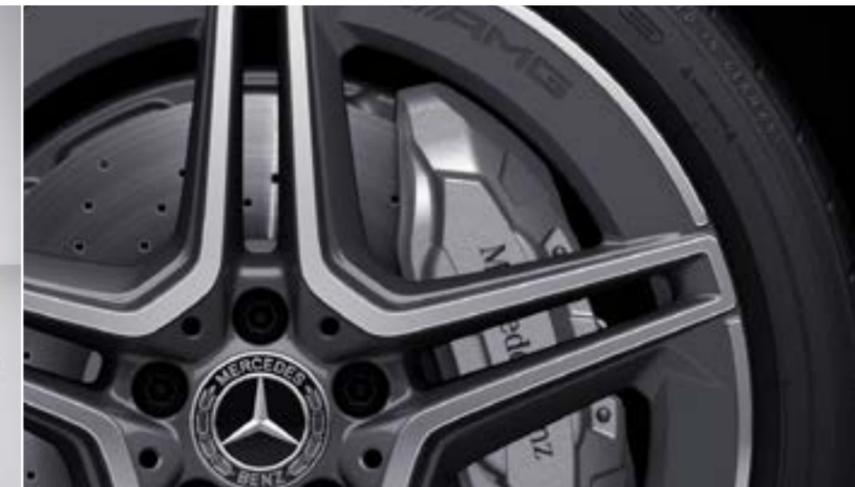
U29 - Sistema frenante con dischi del freno di maggiori dimensioni sull'asse anteriore
