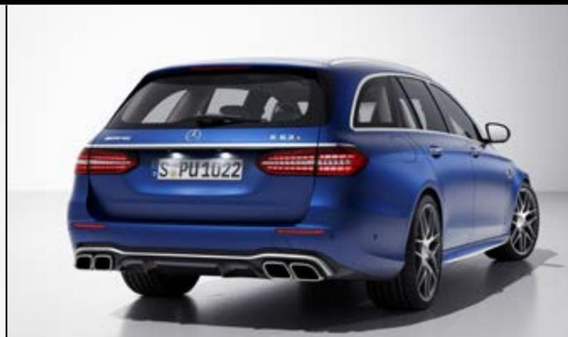
Sistema di scarico AMG con due elementi trapezoidali cromati a due uscite con logo AMG in rilievo e nervature caratteristiche
