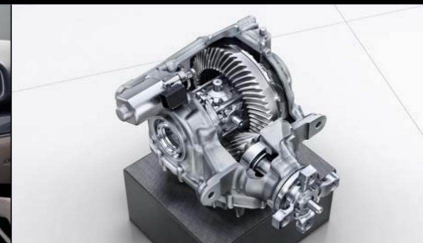
467 – Différentiel électronique autobloquant AMG sur l'essieu arrière
