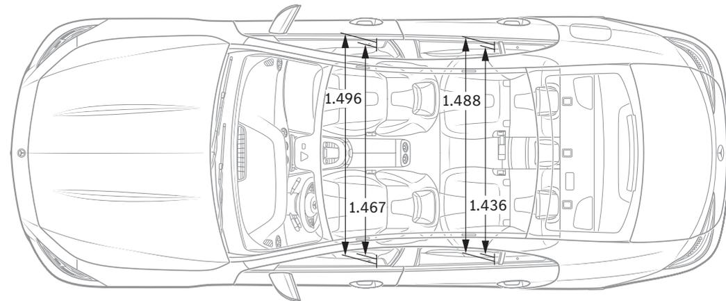
Alle Angaben in Millimetern. Die abgebildeten Masse sind Mittelwerte. Sie gelten für Fahrzeuge in Grundausstattung und in unbelastetem Zustand.
