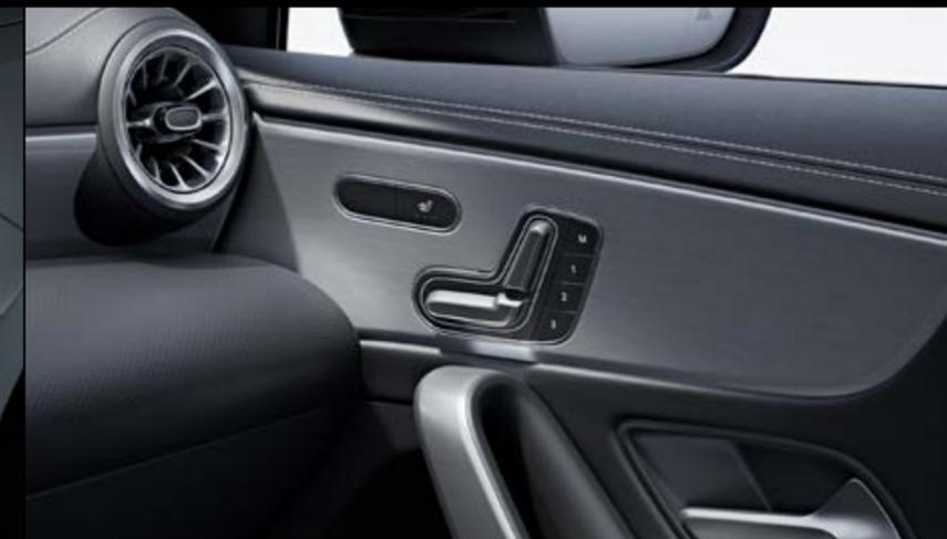
275/242 - Sedile conducente, elettronicamente regolabile e con funzione memory
