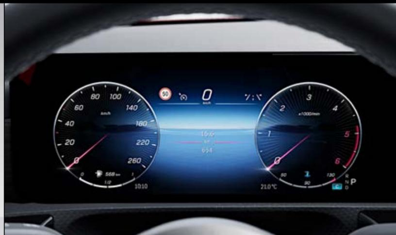
458 - Display della strumentazione completamente digitale
